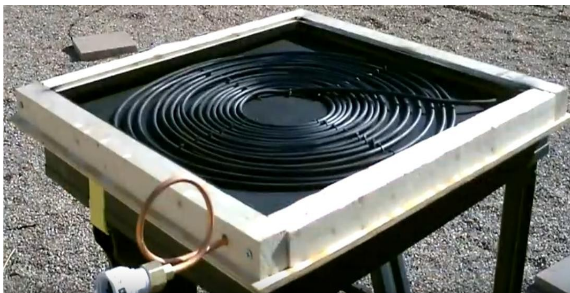
Pannello solare con telaio di legno e spirale di rame verniciata (va poi inserito un vetro in alto all'interno del telaio per creare l'effetto serra e impedire al caldo di uscire).
